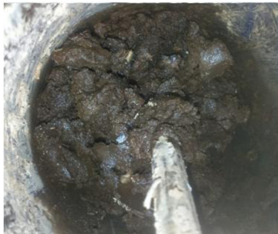
Рис. 9. Изменение консистенции и окраски при смешивании ШЛ и СаО (образец 2, партия 1)
