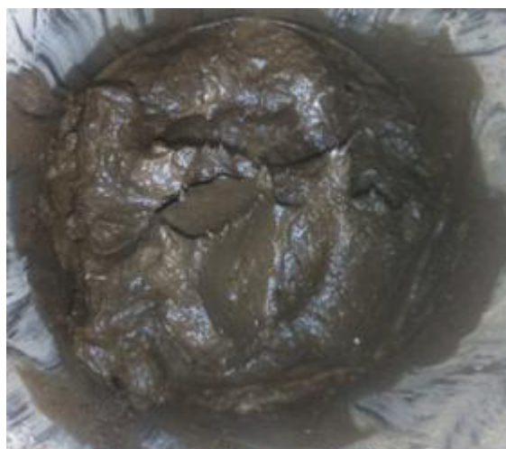
Рис. 12. Изменение консистенции и окраски при смешивании лигнина и СаО (образец 3, партия 2)
