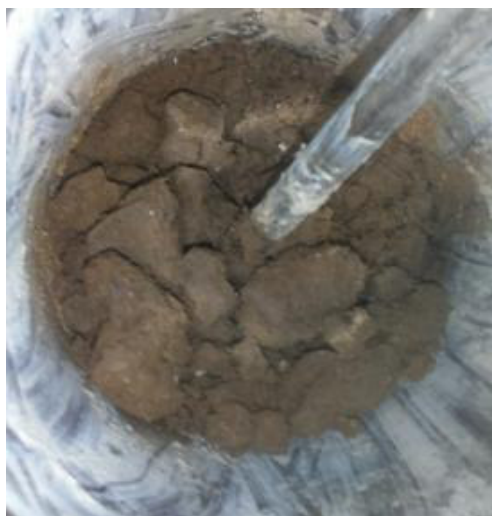
Рис.17. ШЛ+СаО, образец 3, партия 2 (масса затвердела, не перемешивается, видно закаменевшую массу)
