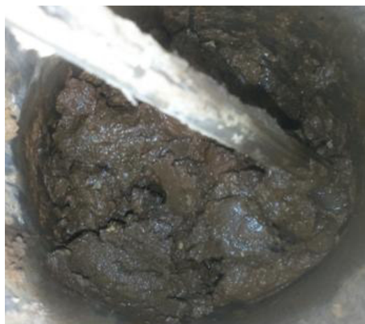
Рис. 10. Изменение консистенции и окраски при смешивании ШЛ и СаО (образец 3, партия 1)
