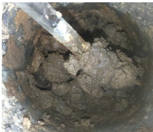
Рис. 11. Изменение консистенции и окраски при смешивании ШЛ и СаО (образец 4, партия 1)
