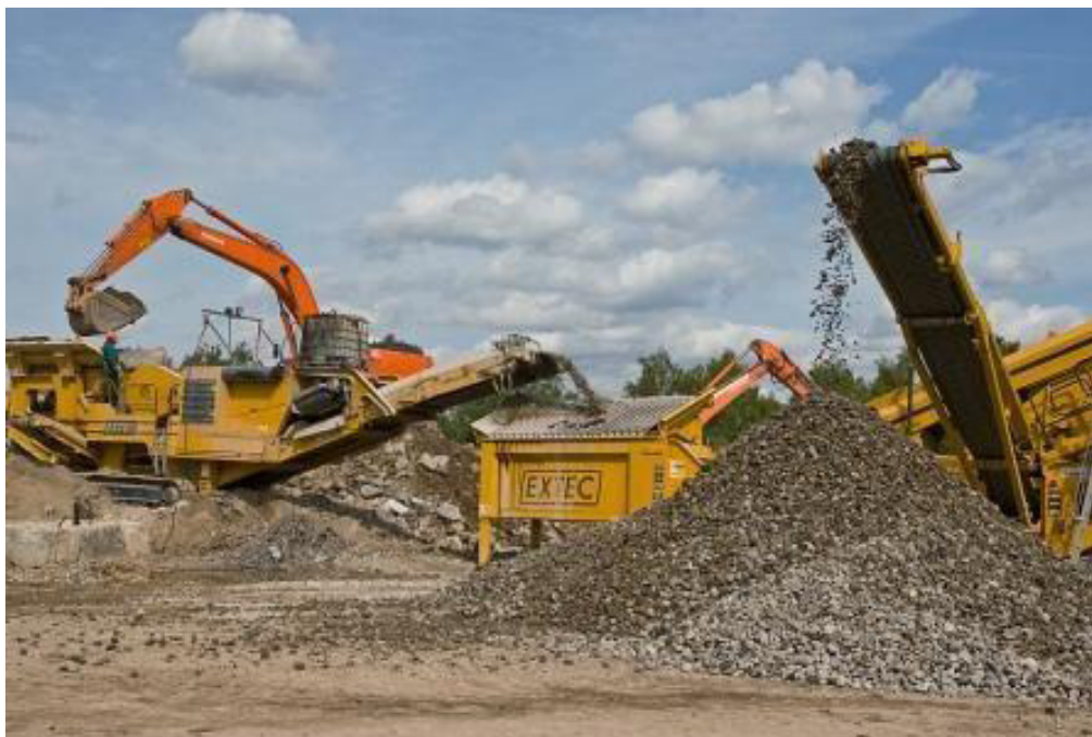
Рис. 2. Переработка бетона в щебень с его фракционированием на современном комплексе по дроблению («Умный снос»)
