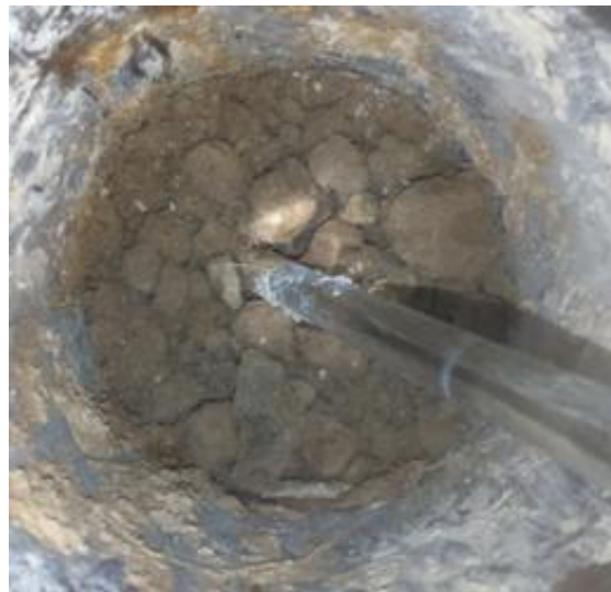
Рис. 16. ШЛ+СаО, образец 4, партия 2 (масса затвердела, не перемешивается, видно закаменевшую массу)
