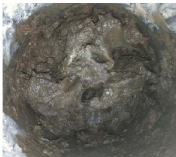
Рис. 13. Изменение консистенции и окраски при смешивании лигнина и СаО (образец 4, партия 2)
